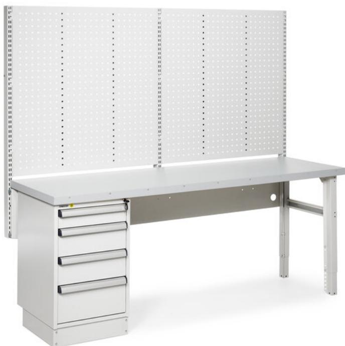
Établi Workshop charge légère avec plateau en acier de 2000x630. Unité de tiroirs 45 comprenant 4 tiroirs. Montants avec panneaux perforés de 1003 mm de hauteur. Capacité de charge de 550 kg. Hauteur de travail de 800 mm.
